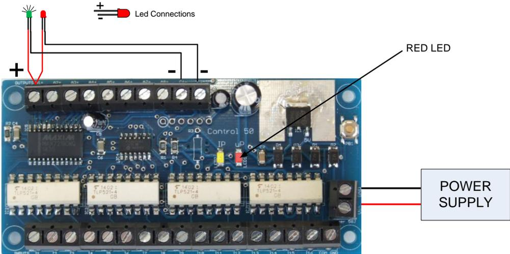
1. CONNECT POWER SUPPLY (BETWEEN 10V AND 25V DC)
